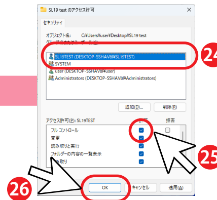
㉔追加されたユーザー名を選択して ㉕「フルコントロール」をチェックし、 ㉖「OK」をクリックします。
