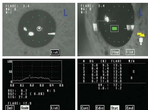
FM-600は、レーザー光散乱法を用いた測定装置です。前房にレーザー光を照射することで、房水中の蛋白濃度を、非接触・非侵襲で定量測定します。房水中の蛋白で反射したレーザー散乱光は、光電子増倍管を通じて数値化され、蛋白濃度に比例した散乱光強度を、フレア値として表示します。
